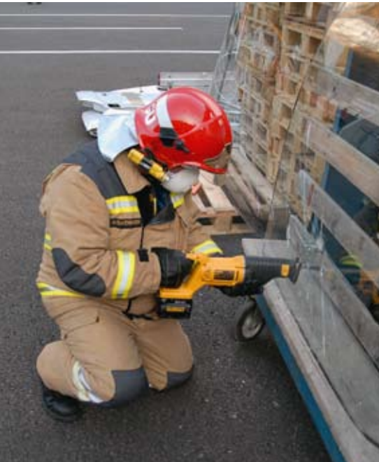
Beim Aufschneiden der Windschutzscheibe müssen sämtliche Vorsichtsmassnahmen beachtet werden.
