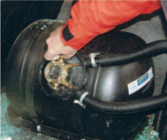
Réservoir de gaz liquéfié: la fermeture de la soupape interrompt l'alimentation en gaz. Les tuyaux noirs enveloppent les véritables conduites de gaz et évacuent de l'intérieur du véhicule à l'air libre le gaz s'échappant.
